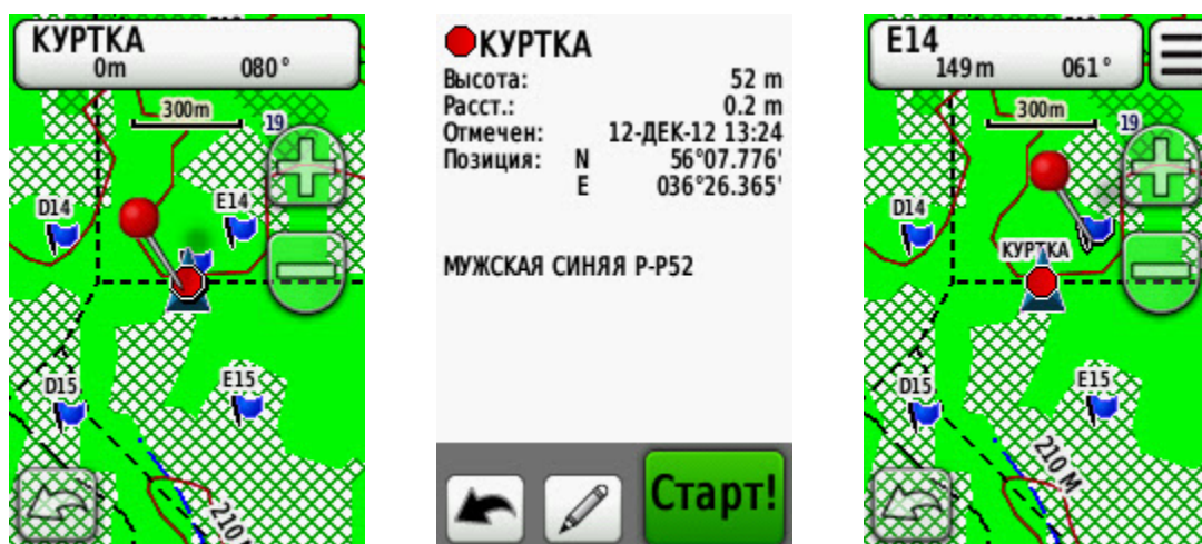
Рисунок 19 (а,б,в). Указание своего местоположения с помощью азимута и расстояния до точки привязки.
