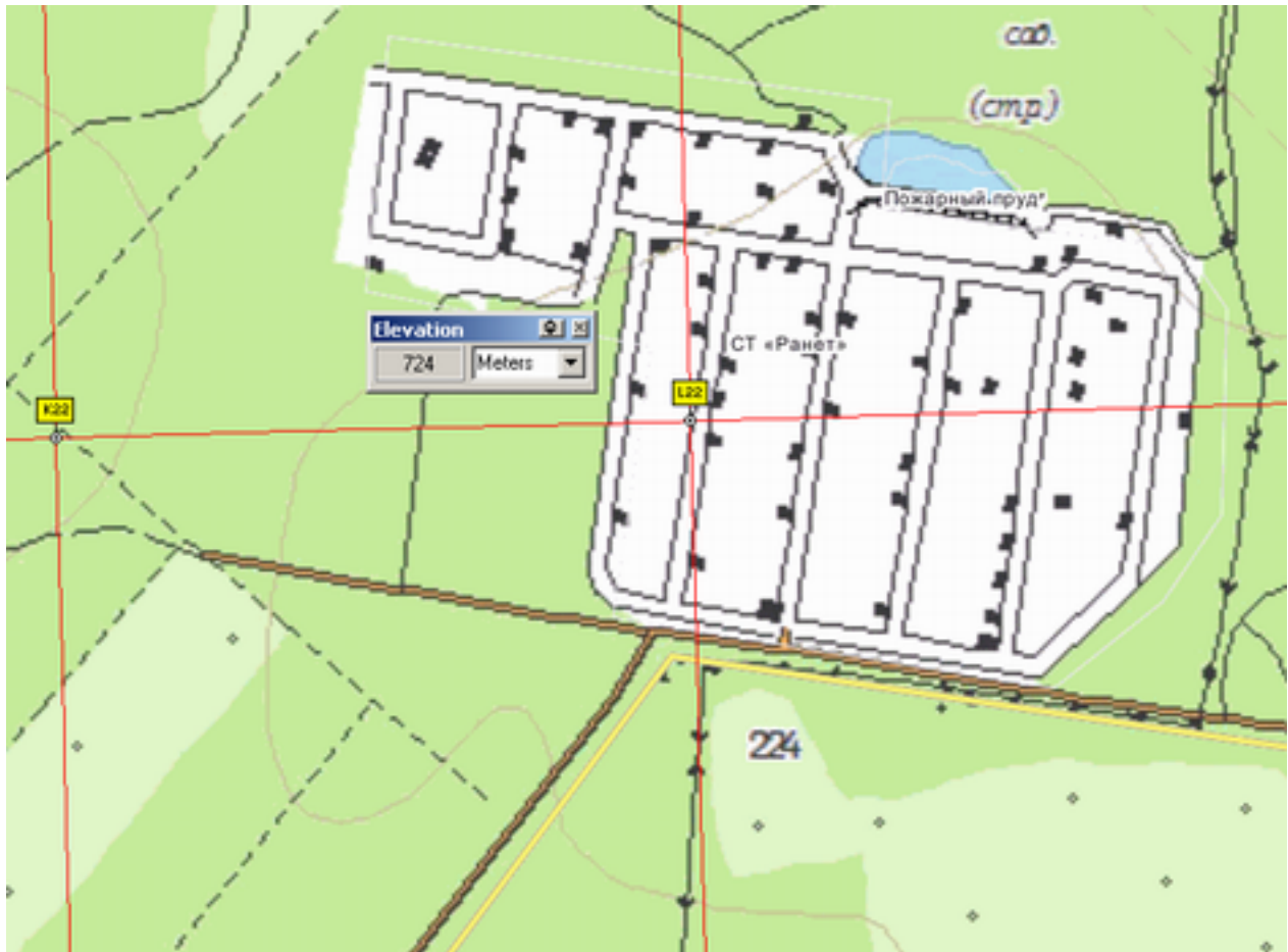
Рис. X. Дополнительное поле с данными высот в OziExplorer.
