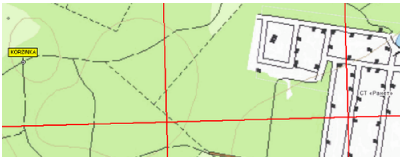
Рис. X. Маршрутная точка, импортированная в OziExplorer с навигатора Garmin.
